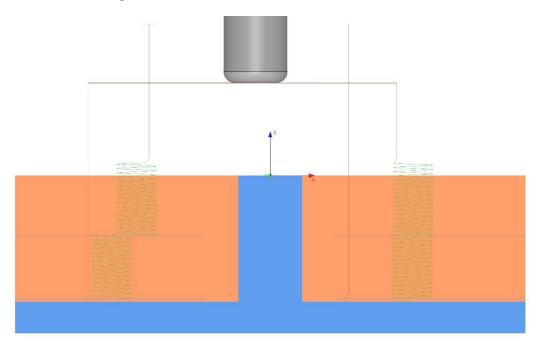
Mit Version 19.0.05 wird der Sicherheitsabstand nicht mehr auf die Oberseite des Bauteils angewandt. Das heißt, durch herabsetzten der Sicherheitsebene kann die Höhe der Positionierbewegung über dem Bauteil reduziert werden. Im Bild unten wurde die Sicherheitsebene auf 3mm gesetzt und der Fräser positioniert auf dieser Höhe.
