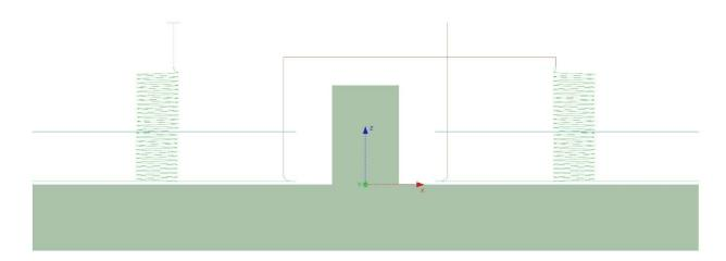
Die Eilgangbewegung über das Bauteil wird mit dem Wert des neuen Parameters **Abstand zu den Schnitten** ausgeführt. In der Grundeinstellung entspricht der Wert der halben Stufentiefe, jedoch nicht kleiner als 1. Dieser Wert kann vom Anwender auf einen niedrigeren Wert geändert werden. Eine Vergrößerung ist bis zum selben Wert von **Abstand zur Fläche** möglich.
