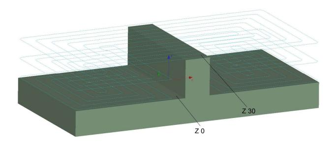
Der Dialog oben zeigt die Grundeinstellung bei diesen Parametern. Wenn mit einer Stufentiefe von 15 mm gefräst wird, kann es in komplexeren Teilen unter Umständen vorkommen, dass in Bereichen, die der Fräser nicht erreicht, Material mit einer Höhe von 15 mm stehen bleibt. Daher ist der Abstand zur Fläche auf 17 mm eingestellt. Dieser Wert kann nicht unter die Stufentiefe reduziert werden.
