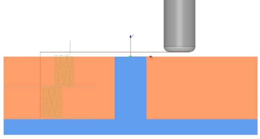
Das Positionieren wurde auch in anderen Bereichen verbessert, z.B. wenn auseinanderliegende Bauteile bearbeitet werden und sich der Fräser beim Positionieren außerhalb der Begrenzung und des Bauteils bewegt.
