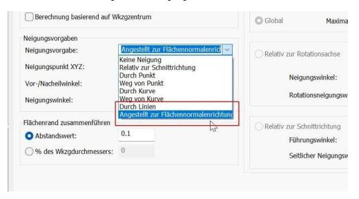
**Bei Angestellt zur Flächennormalenrichtung** wird ein weiterer Flächenordner angewählt, dessen Flächen die Neigung bestimmen. Das Werkzeug stellt sich senkrecht zu diesen Flächen. Im Bild unten wird als Beispiel einfach eine ebene Fläche bearbeitet, und die roten Flächen bestimmen die Richtung der Werkzeugachse.
