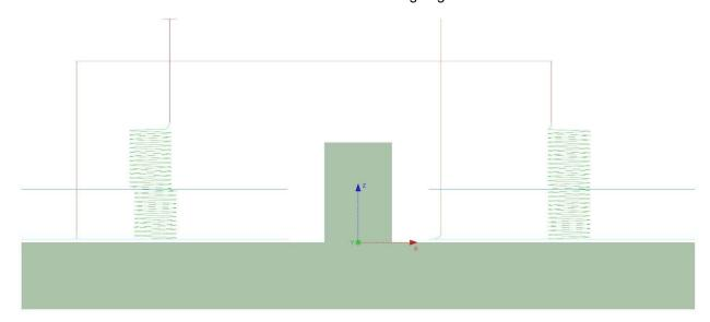
Die Positionierungsbewegung im Eilgang von einer Seite zur anderen erfolgt sehr hoch über dem Teil. Dies liegt daran, dass der Wert Abstand zur Fläche auch auf der Oberseite des Teils angewendet wird.
