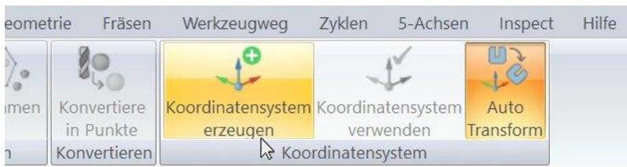
Es wird ein Koordinatensystem im Verzeichnisbaum mit der entsprechenden Position und Ausrichtung erstellt, mit dem dann das Bauteil ausgerichtet werden kann.
